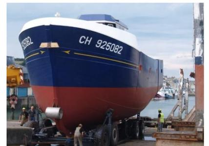
**Vendredi 4 octobre matin, le chalutier est progressivement hissé à l'aide d'une grue et installé sur le chariot du slip-way.**
