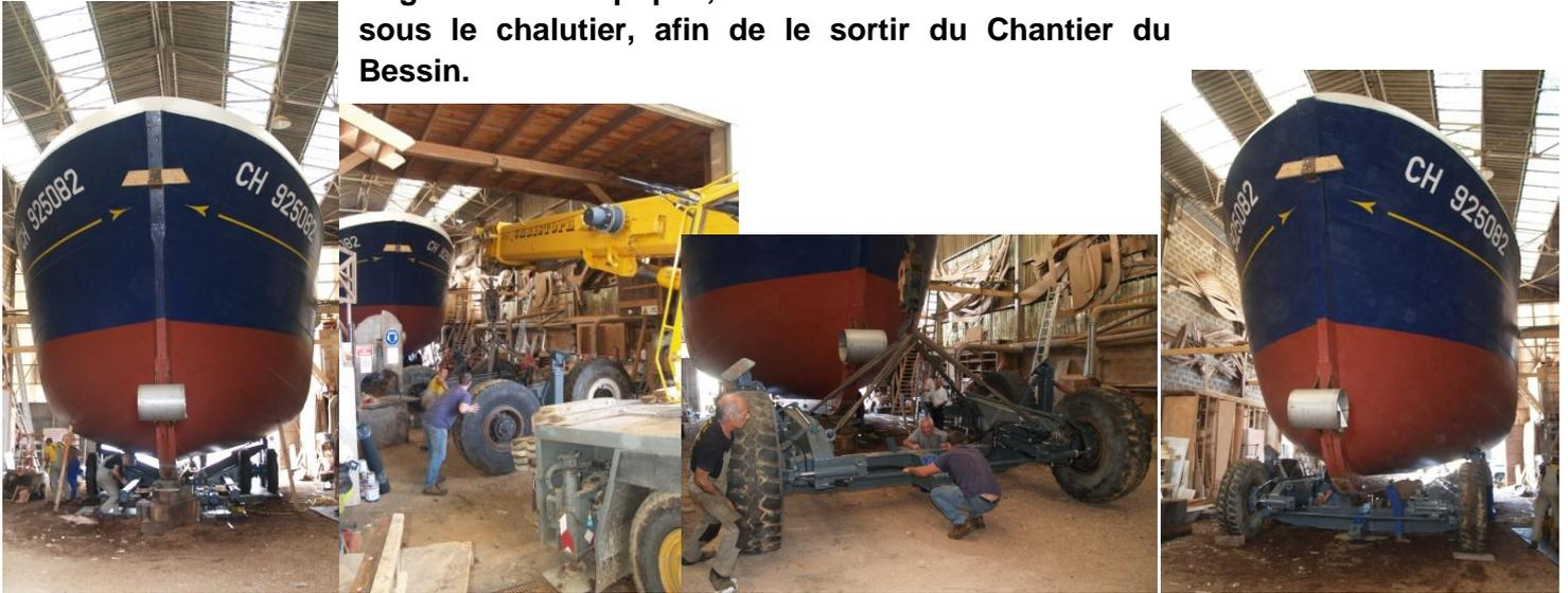
Jeudi 3 octobre dans la matinée, le chalutier sort pour la première fois du Chantier du Bessin. Placé sur un chariot la veille, il est remorqué à l'extérieur du chantier naval pour rejoindre le chariot du slip-way.
