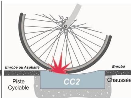
*Le module type CC2 est déconseillé car constituant un piège épousant partiellement la forme de la roue.*
